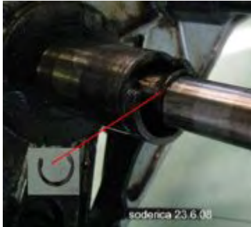
der letzte Sicherungsring auf der Welle v. der Junction Box demontierte Konsole mit Welle
