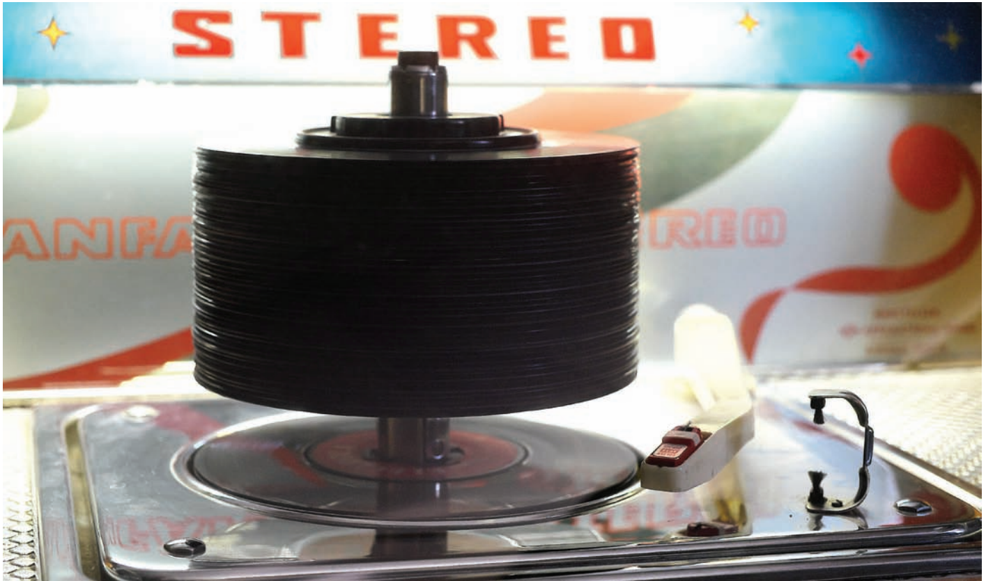
Interessant, aber störanfällig: der Stapelmechanismus der „Klack-klack-Fanfare“. Foto: Felix de Cuveland
